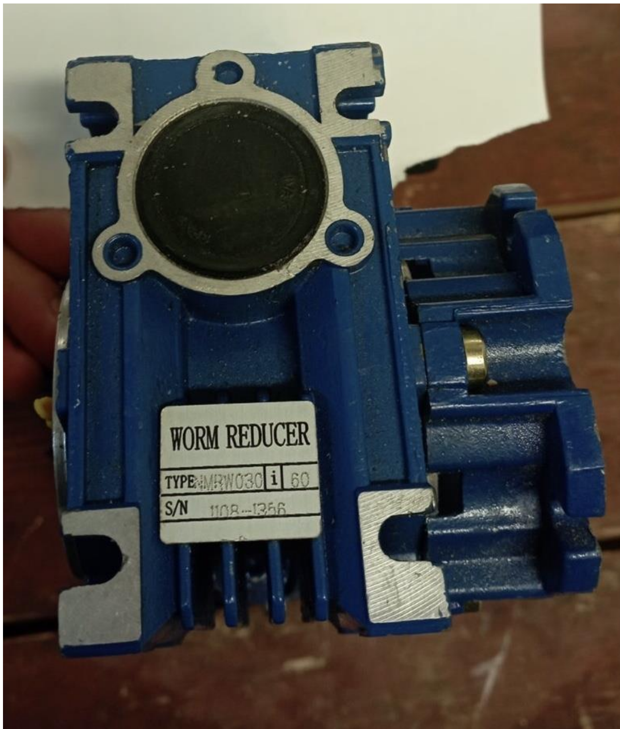
Мотор редуктор NMRV030-60-23,3-0,18
