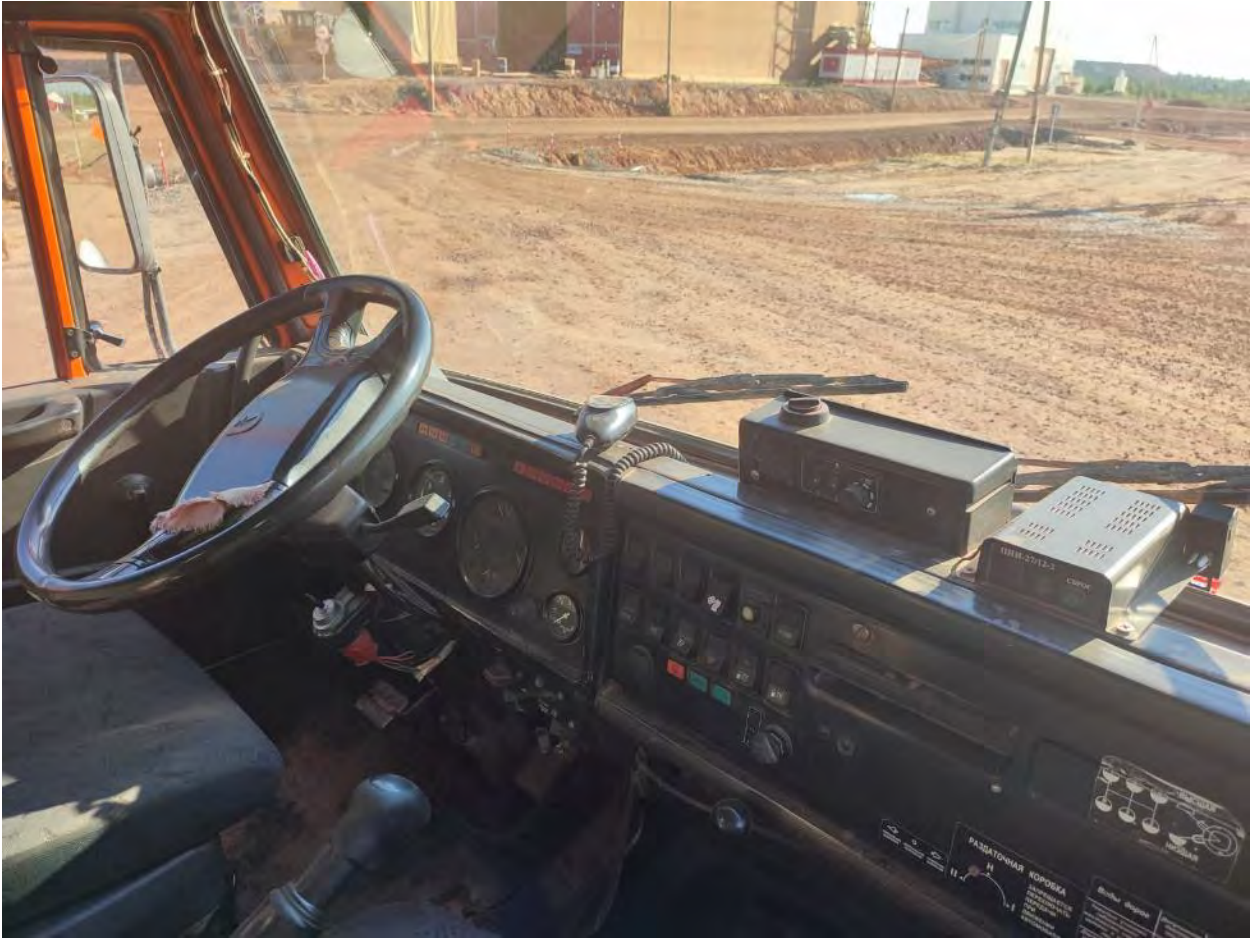
Фото НефАЗ-42111-10-11 2011г.в. с тахографом КАСБИ ДТ-20М:
